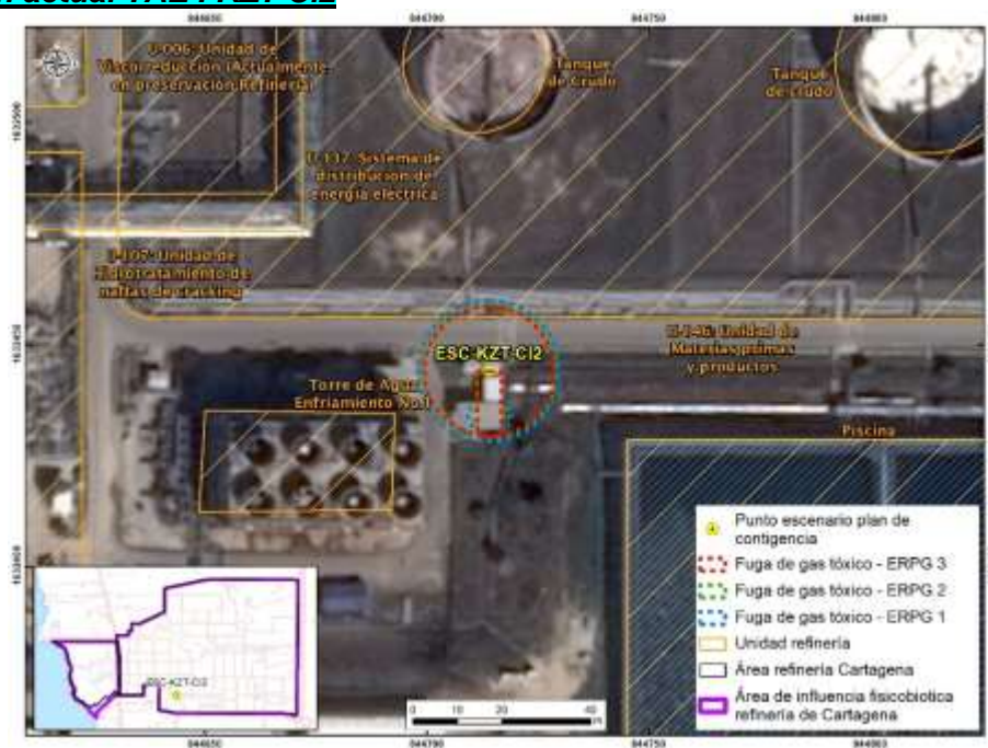
Figura 9-57 Área de afectación del escenario de cloro en la TAE I en condiciones de operación actual TAE I KZT C12
