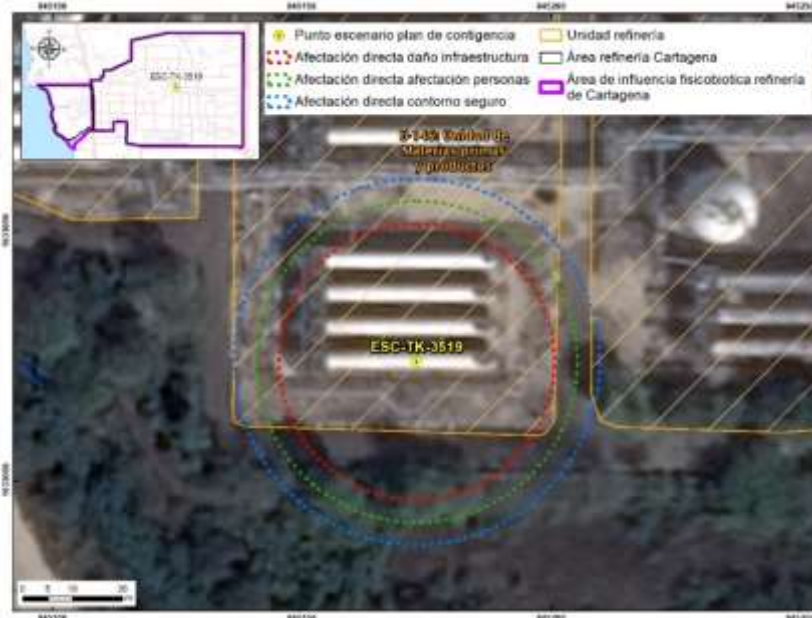
Figura 9-77 Dardo o chorro de fuego – Tanque TK-3519
