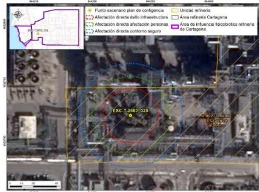
Figura 9-65 Dardo o chorro de fuego – Línea fondo torre T-2603
