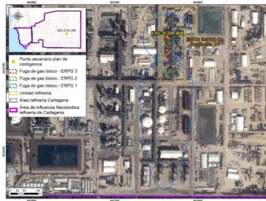
Figura 9-85 Fuga de gas tóxico – HF en D-04 unidad U-44
