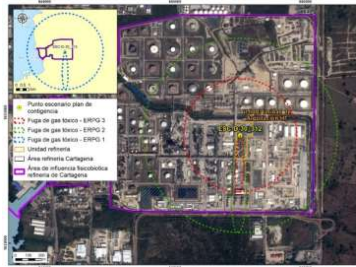
Figura 9-84 Fuga de gas tóxico – HF en D-30 unidad U-44
